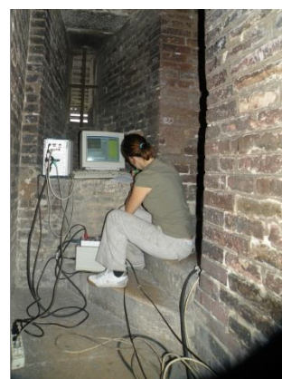
Fig. 1.130 – a) Preparazione di una griglia; b) emissione e ricezione del segnale sonico; c) acquisizione dati.
