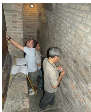
Fig. 1.42 – a) Elaborazione dello schizzo della parete OB; b) Preparazione di alcune griglie di prova; c) Acquisizione dei dati.
