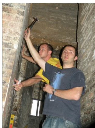
Fig. 1.130 – a) Preparazione di una griglia; b) emissione e ricezione del segnale sonico; c) acquisizione dati.
