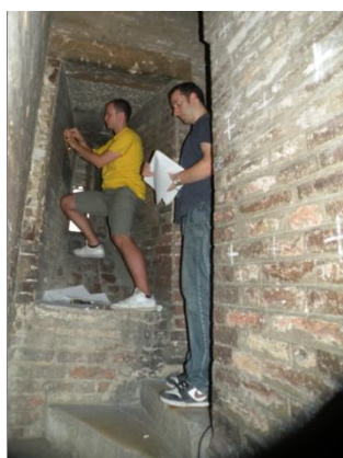
Fig. 1.130 – a) Preparazione di una griglia; b) emissione e ricezione del segnale sonico; c) acquisizione dati.
