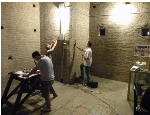
Fig.1.70 – Realizzazione di prove semidirette fra le pareti SB e OA.
