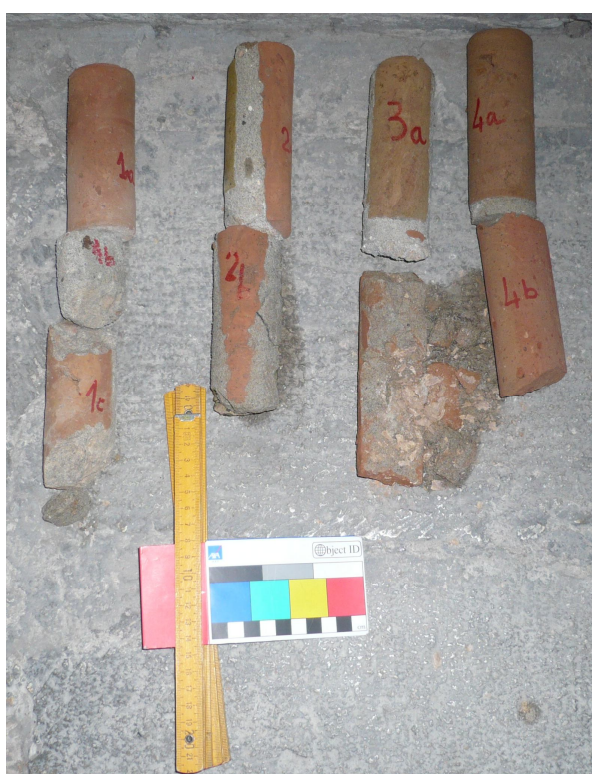
Fig. 3.3: Esempio di microcarote estratte ad una posizione di prova (quota 10 m).
