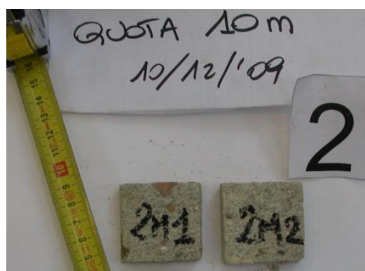
Fig. 4.2: Esempio di provini di malta ricavati da una carota (quota 10 m, carota 2).
