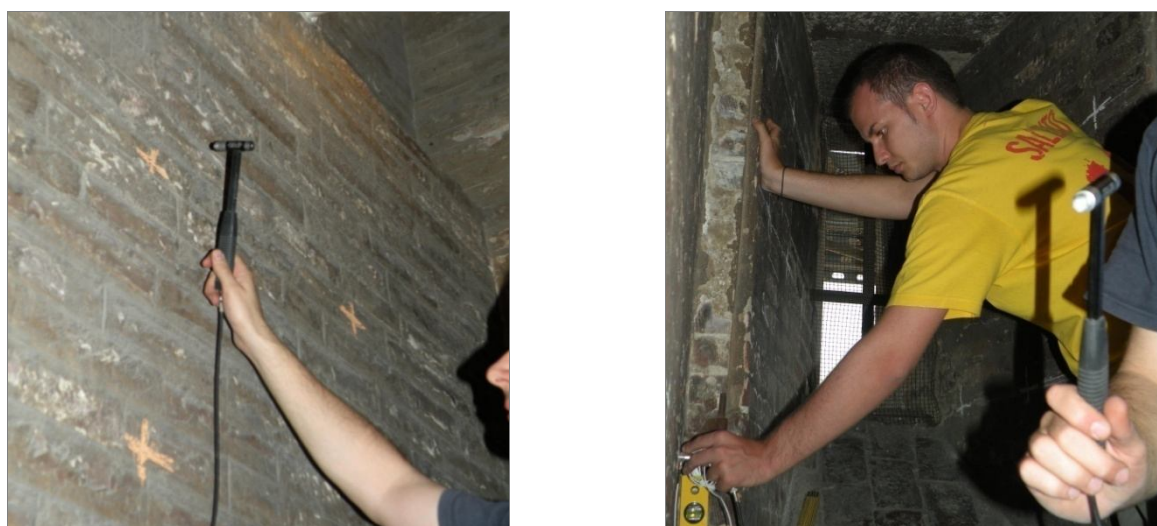
Fig. 1.132 – Realizzazione di prove superficiali sulla parete OD.
