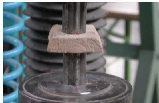
Fig. 4.4: Prova di doppio punzonamento malte: schema di carico ed esecuzione di una prova
