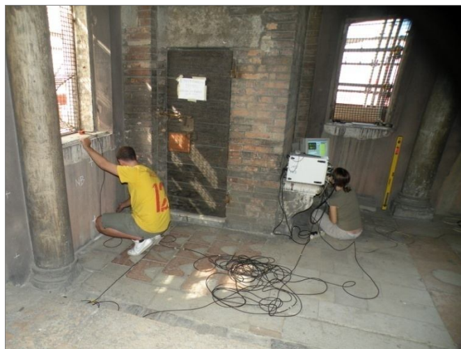
Fig. 1.134 – Realizzazione di prove soniche in corrispondenza della parete OB.
