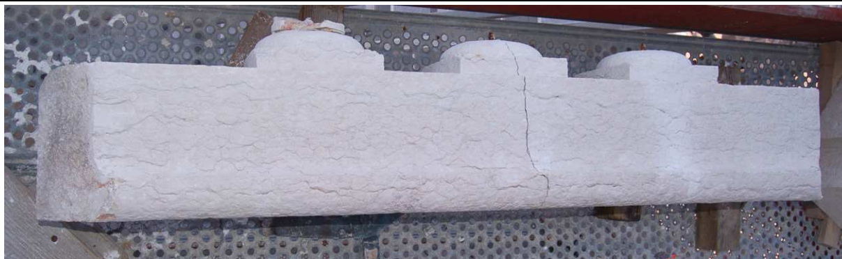
Foto 1: vista generale dell'elemento lapideo, si nota la fessurazione centrale che ne attraversa l'intero spessore
