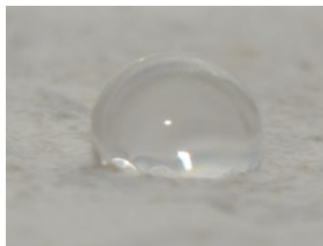
Fig. 2, Area AC3 della balastra inferiore, prova di angolo di contatto
